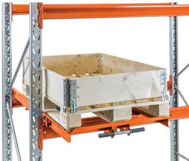
Útdraganleg brettahilla - fyrir geymslu smáhluta. Festist á bita, burðarþol 700 kg.
