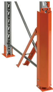
Ákeyrsluvörn 90, há - notist með fótplötu, gefur mjög góða vörn þar sem álag er mikið. Hæð 760 mm
